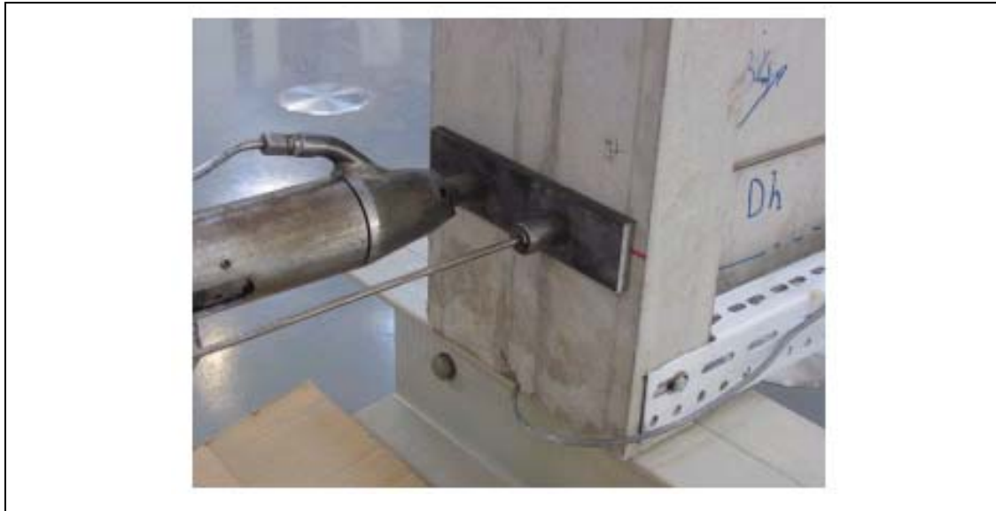
Figura 6.49 – Aplicação de protensão na viga-parede para nova experimentação
